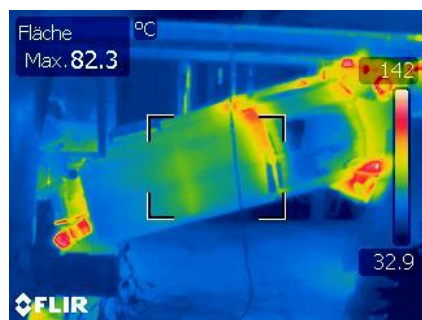
Abb. 2 Wärmebildaufnahme der Reaktoren während der Versuche
